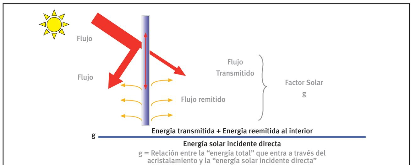
Aunque normalmente los vidrios de control solar se instalan en UVA para obtener una buena transmitancia térmica, en muchos casos pueden ser utilizados como vidrios monolíticos cuando la prioridad es la protección térmica frente a la radiación solar directa.
